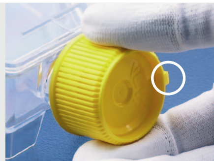
VENT-posição 3 horas = selado
