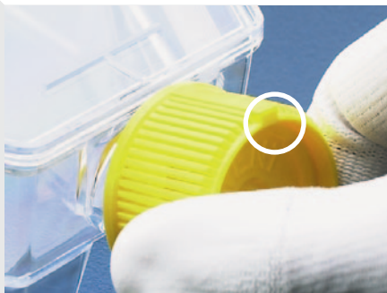
VENT-posição às 12 horas = troca de gás
