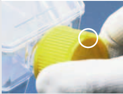
VENT-Position 12 Uhr = Gasaustausch
